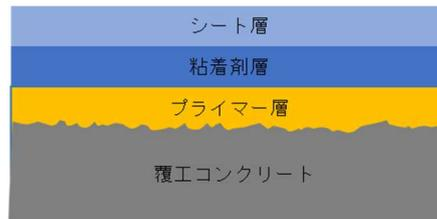
図-3 粘着シート工の断面構成
